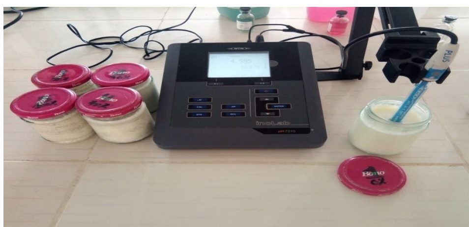
Figure III. 5: Mesure du pH par un pH mètre
