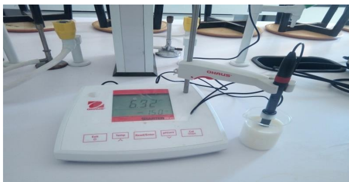
Figure III. 3: photographie de mesure du pH par un pH mètre
