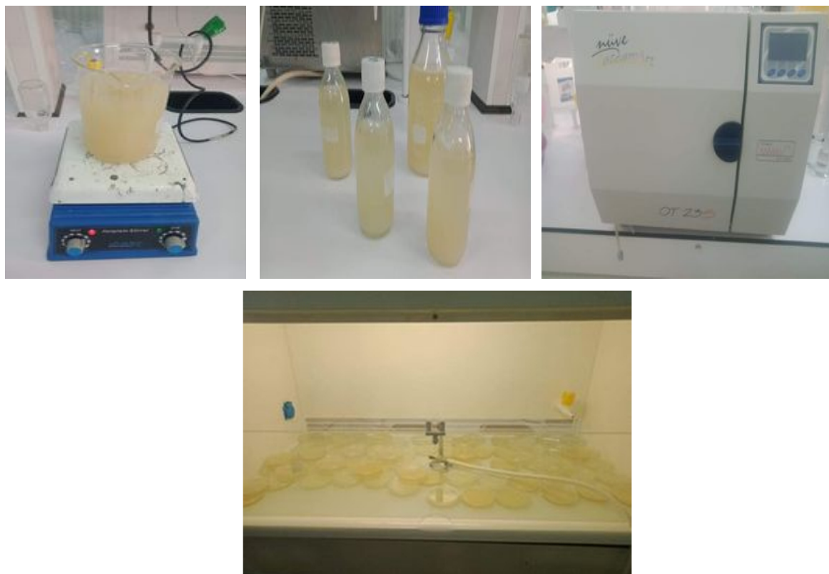
Figure 19 : Étapes de préparation du milieu PDA
