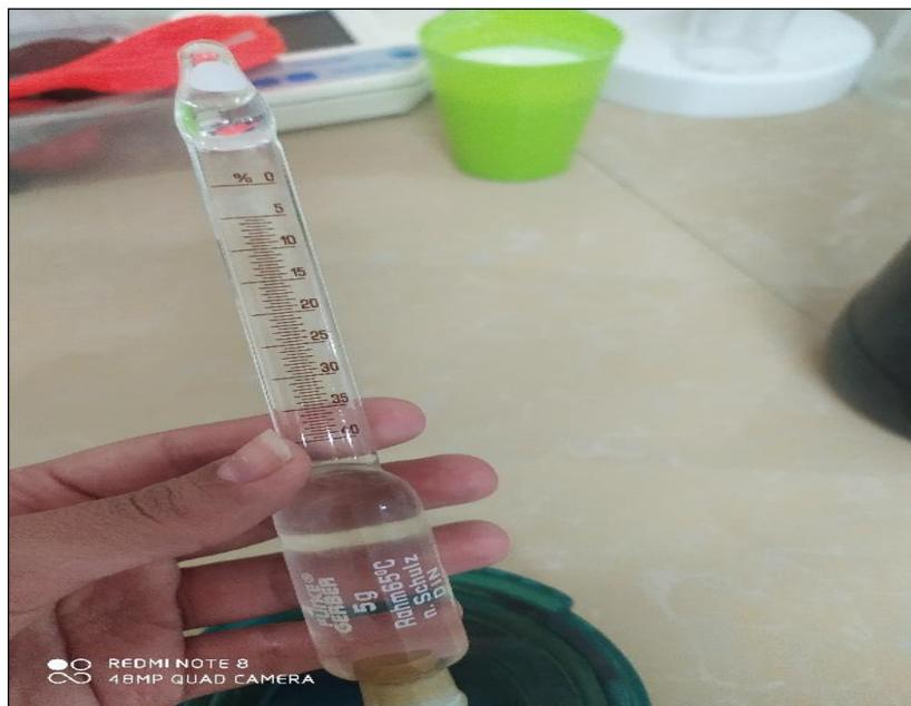
Figure 7: butyromètre (originale ,2022).
