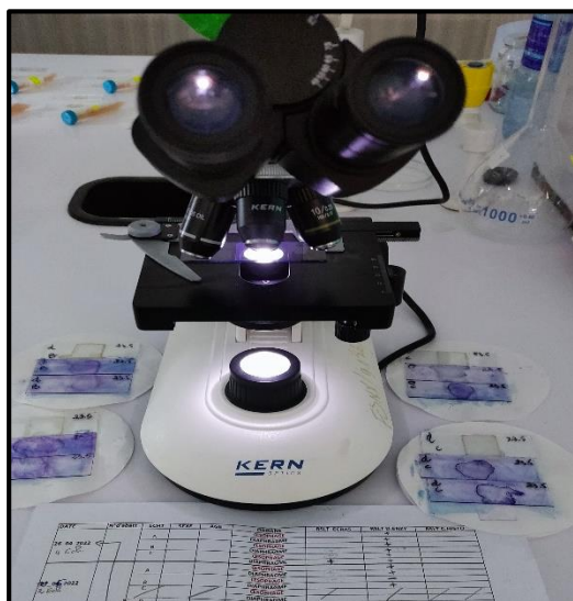
Figure 21 : l'observation des lames par microscope optique grossissement \times 40 . (Originale,2022).
