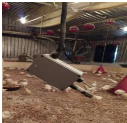
Figure 16 : La sonde (mesure de T°)
