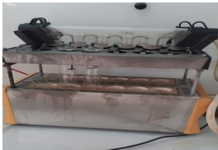
Figure 17: minéralisation de la prise d'essai (photo personnelle)
