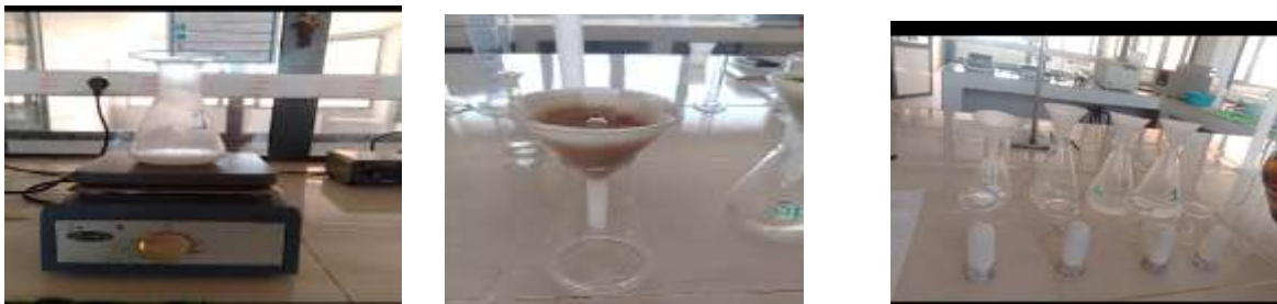
Figure 07 : Dosage de la matière grasse par Soxhlet (photos originales).
