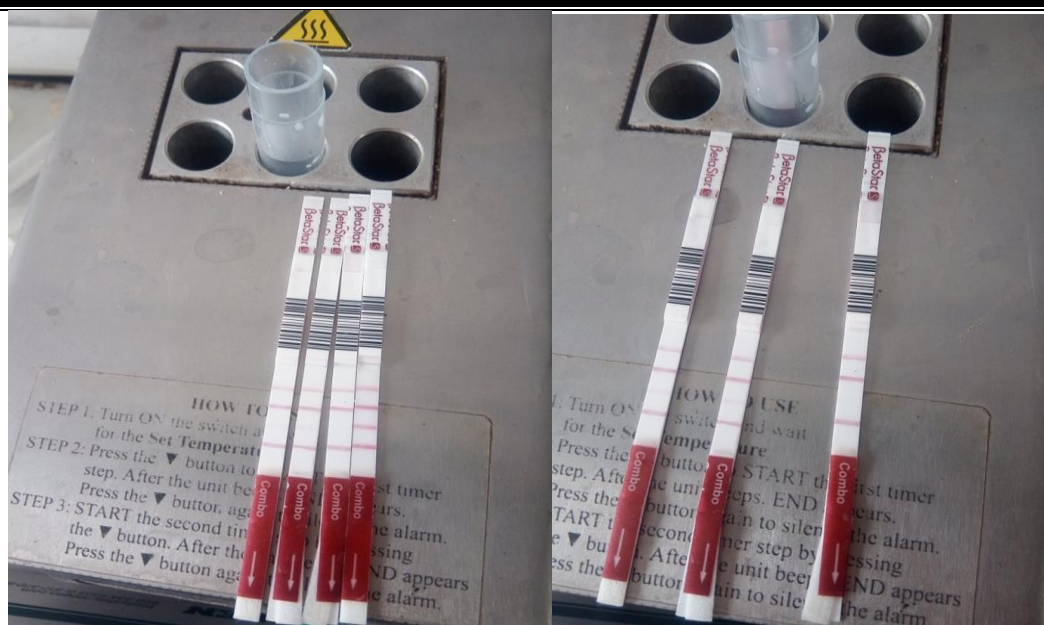
Figure 38: Interprétation des résultats (trois tests positive aux Bêta-lactamine L3). (Photo réelle)
