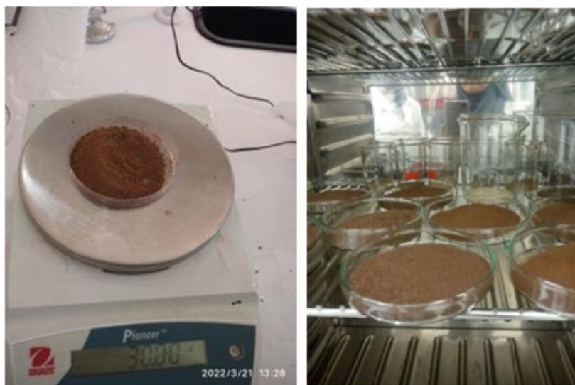
Figure 2-10 : Mesure de l'humidité pondérale H% par la méthode gravimétrique (Laboratoire sol)
