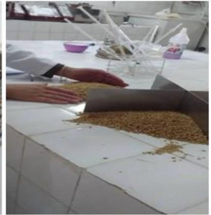
Détermination du poids de mille (1000) grains
