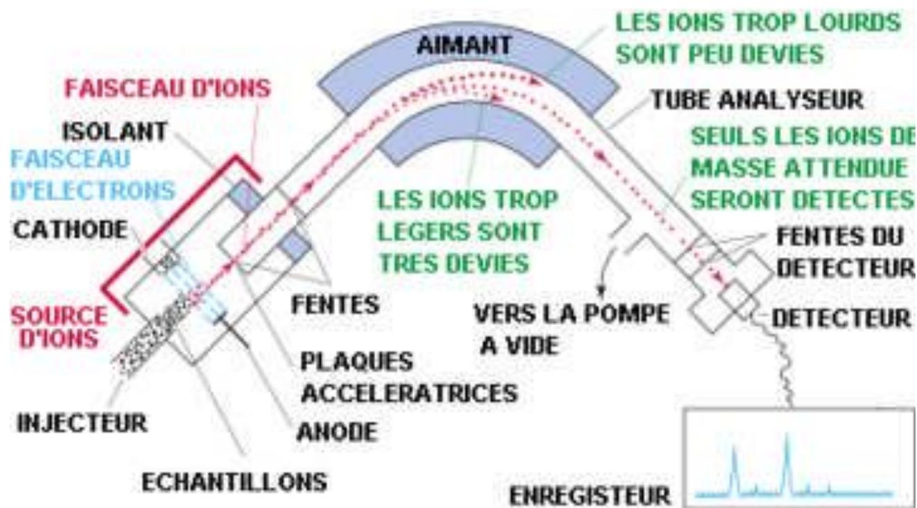
Figure III.1 : Schéma d'un spectromètre de masse.
