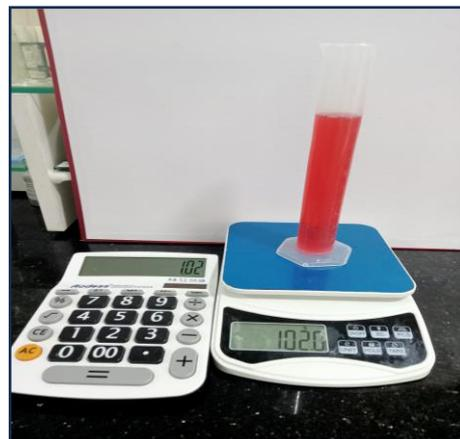
Figure III.7 ; Mesure de la densité
