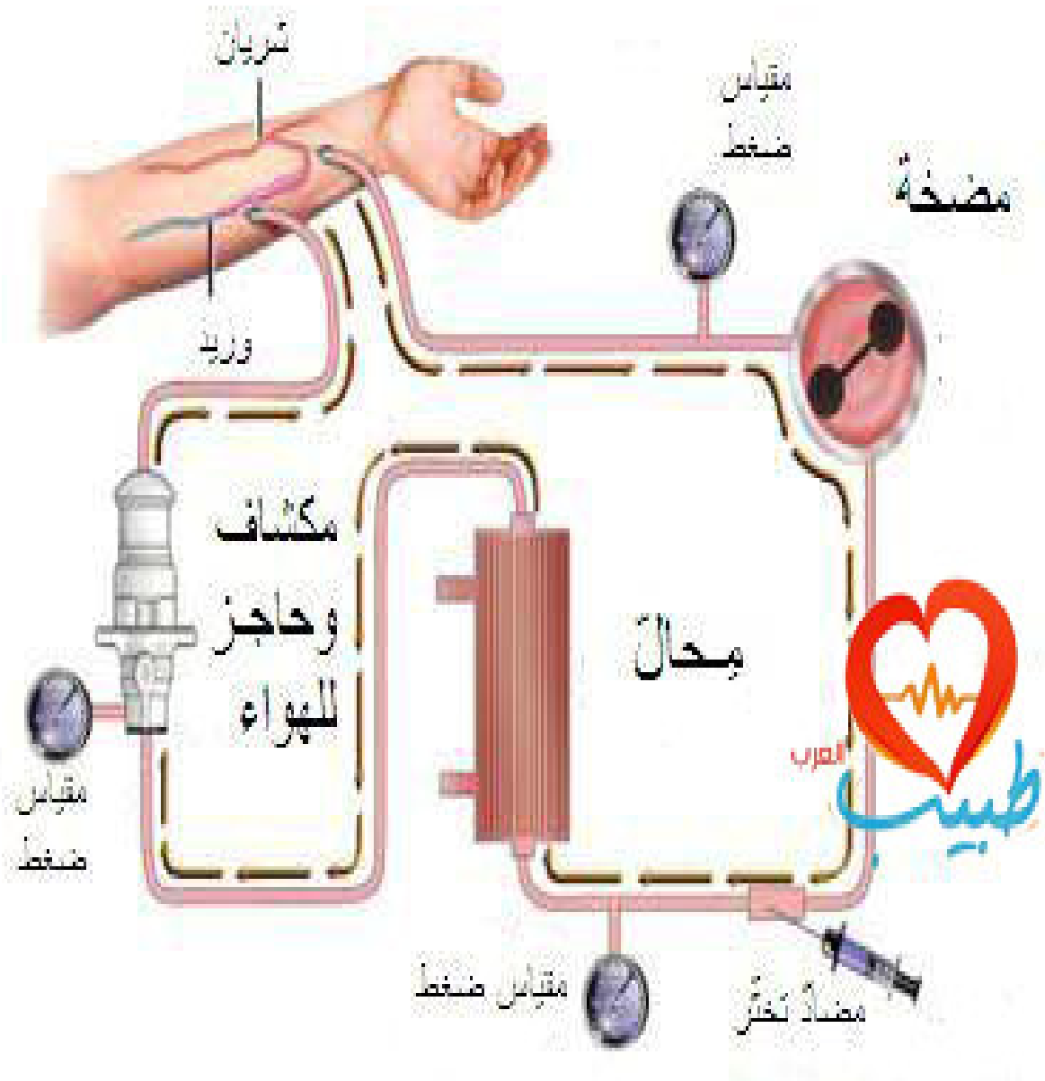
الشكل رقم (02): يوضح مكونات آلة الدياليز وآلية عملها (limage/googel.com).
