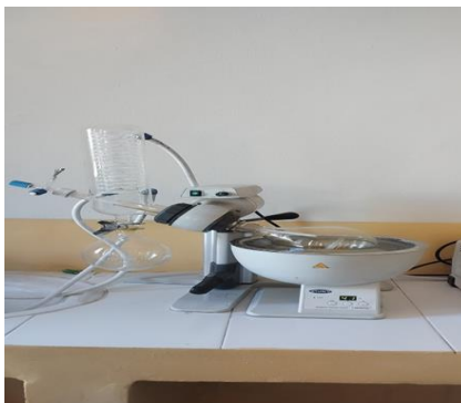
Figure 10 : Rotavapor utilisé pour l'évaporation du solvant d'extraction (originaire)
