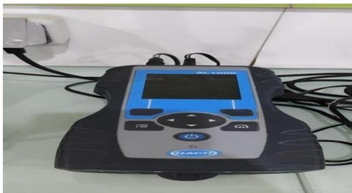
**Figure 10 :** L'instrument HACH SL1000 mesure divers paramètres. (ADE,2024).
