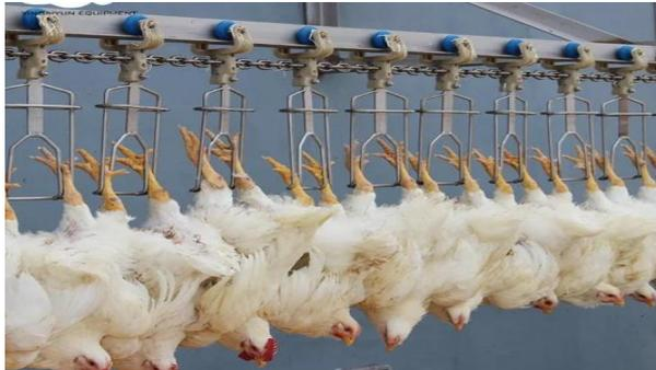
**Figure 6 :** Crochets en acier inoxydable (FAO, 2018).
