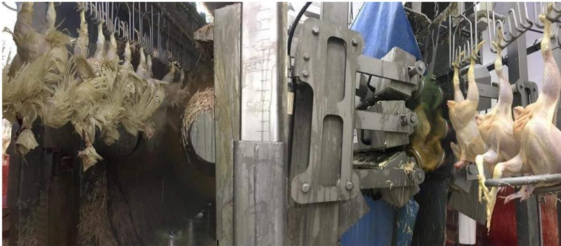
**Figure 19** : La plumeuse et La finisseuse (photo personnelle).
