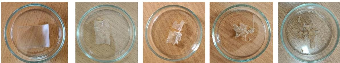
**Figure 17:** Suivi de la biodégradation du film développée pendant 8 jours (Originale, 2024).
