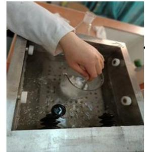
Écouler la solution filmogène sur une plaque et boîtes pétri en verre et laissée pendant 1 semaine
