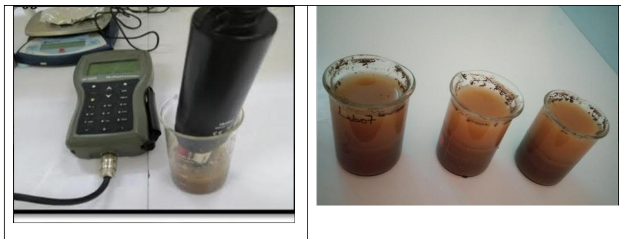
Figure 15 : les étapes de mesure de la conductivité du sol (photos personnelles ,2024).
