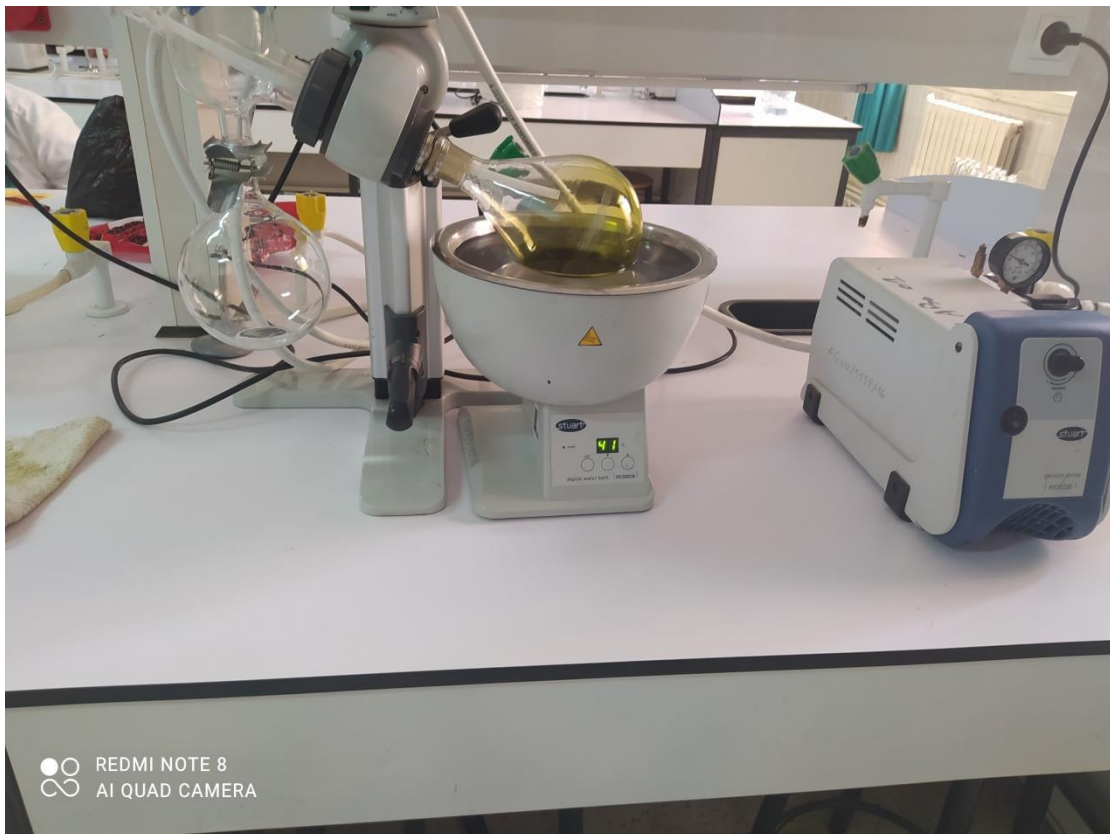
Figure 09 : Evaporation de l'éthanol dans l'évaporateur rotatif.
