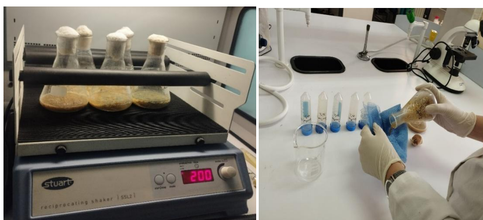
Figure 07: Etapes d'extraction des enzymes d'intérêt à partir des moûts de fermentation via un système d'agitation horizontale.
