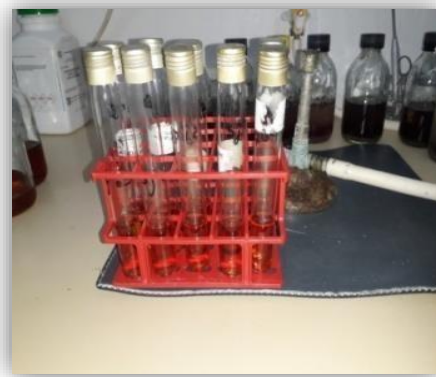
Figure12: Enrichissement bouillon sélénite.
