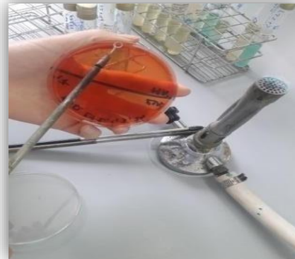
Figure15 : Ensemencement sur XLD.
