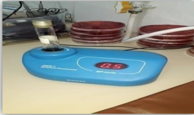
Figure 21: Mesure de l'opacité de la suspension bactérienne par densitomètre.
