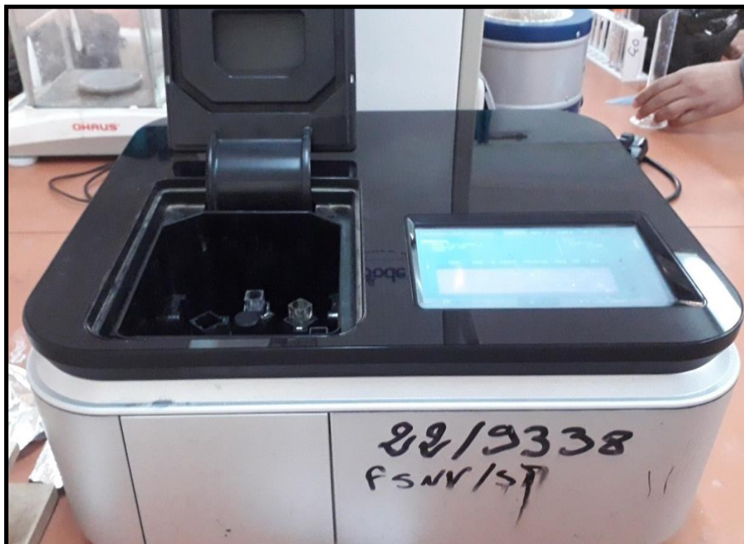
ANNEXE J: Spectrophotomètre (OPTIZEN POP UV/VIS Spectrophotometer) (photos originale).
