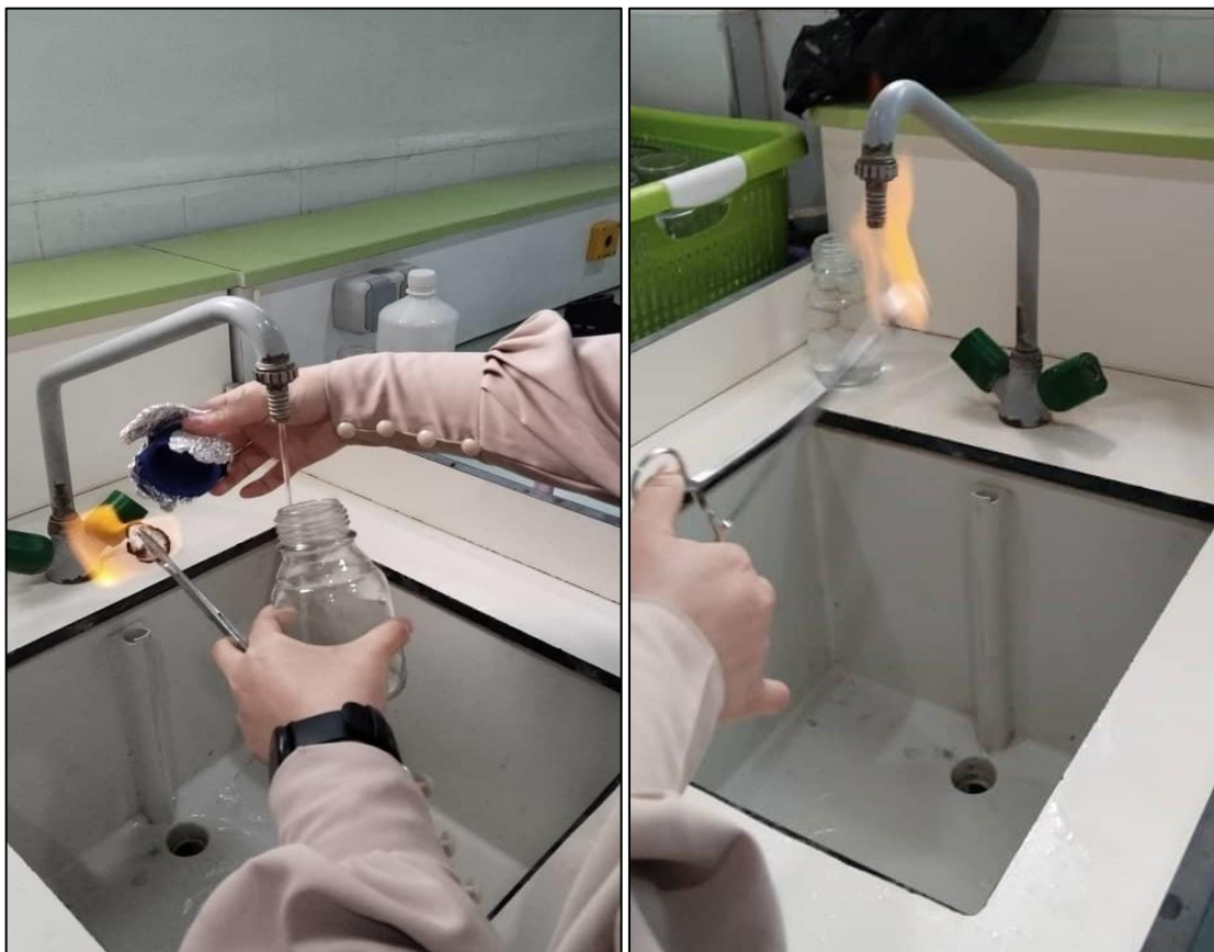
Figure IV.3 : Prélèvement de l'eau de robinet.
