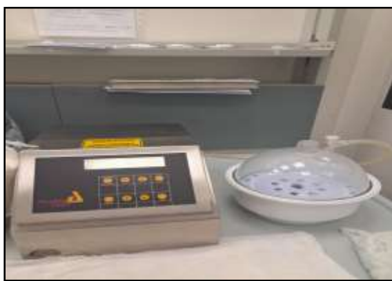
Figure III 5: Cloche à vide avec pompe
