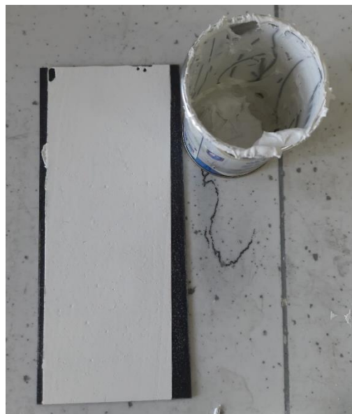
Figure II.19 : Application de gelcoat sur le substrat métallique.
