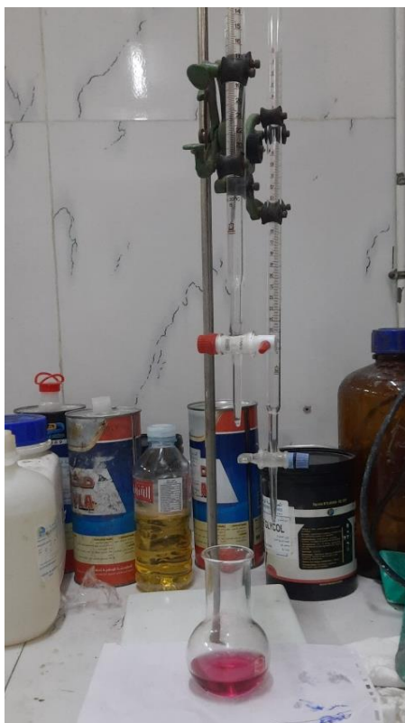
Figure II.7 : Dispositif de titrage pour la détermination de l'indice d'acide.
