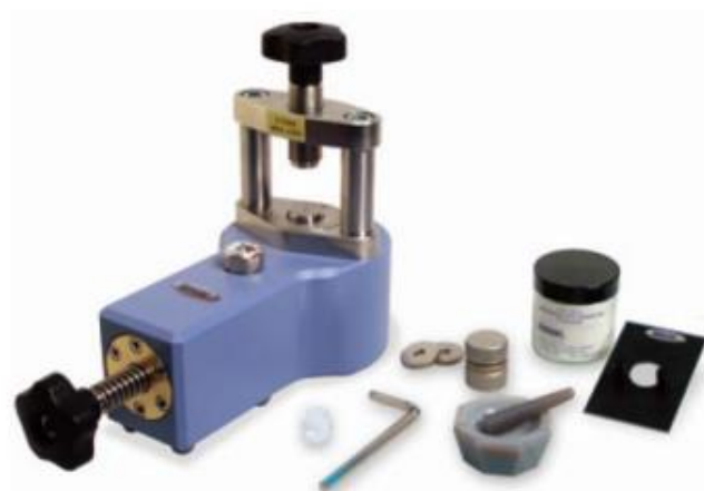
Figure II.15 : Presse hydraulique et accessoires (mortier, moule de pastille) pour préparer la pastille.
