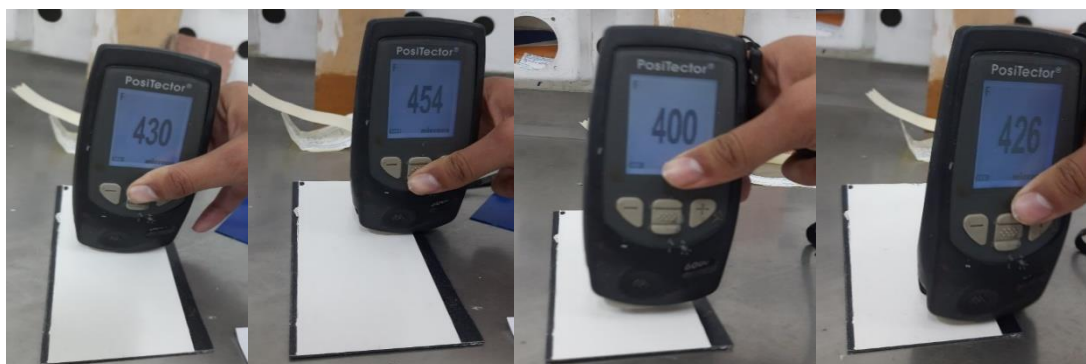
Figure III.7 : Épaisseurs obtenus par le positector à différents endroits.
