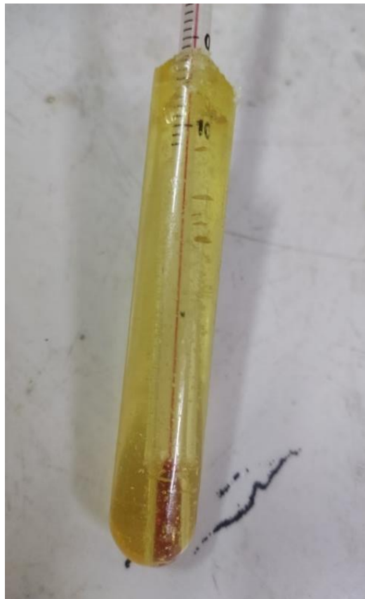
Figure III.3 : Résine dure se forme après une durée de 15 minutes.
