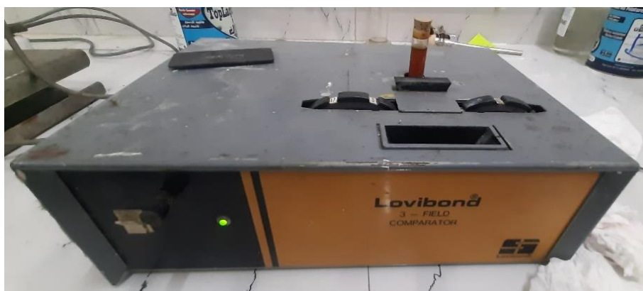
Figure II.12 : Appareillage de test couleur Gardner.
