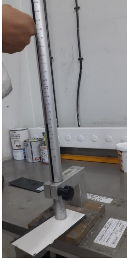
Figure II.21 : Principe de test résistance au choc.
