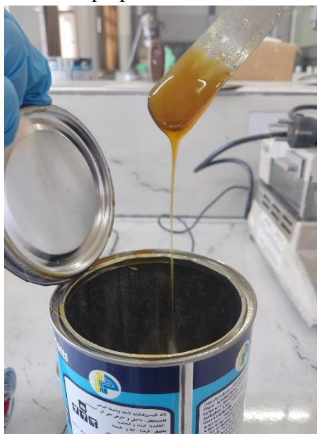
Figure II.5 : Résine polyester insaturé isophtalique préparée.
