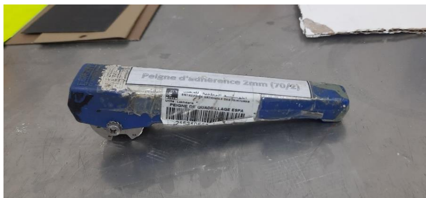
Figure II.20 : Peigne d'adhérence (couteau de quadrillage).
