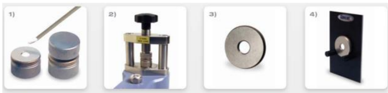
Figure II.16 : Etapes de préparation des pastilles.
