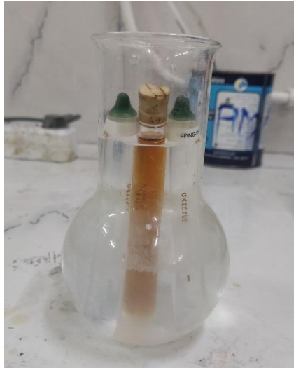
Figure II.10 : Mesure de viscosité Gardner.
