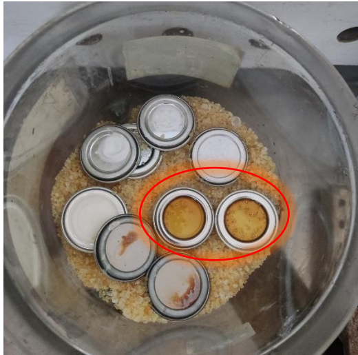
Figure II.9: Echantillons disposés dans le dessiccateur.
