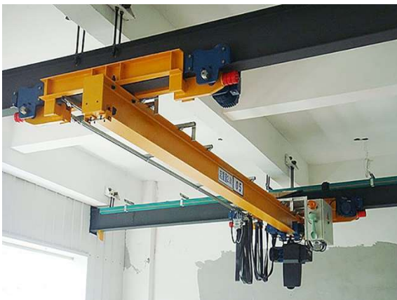
c) Ponts roulants suspendu monopoutre
