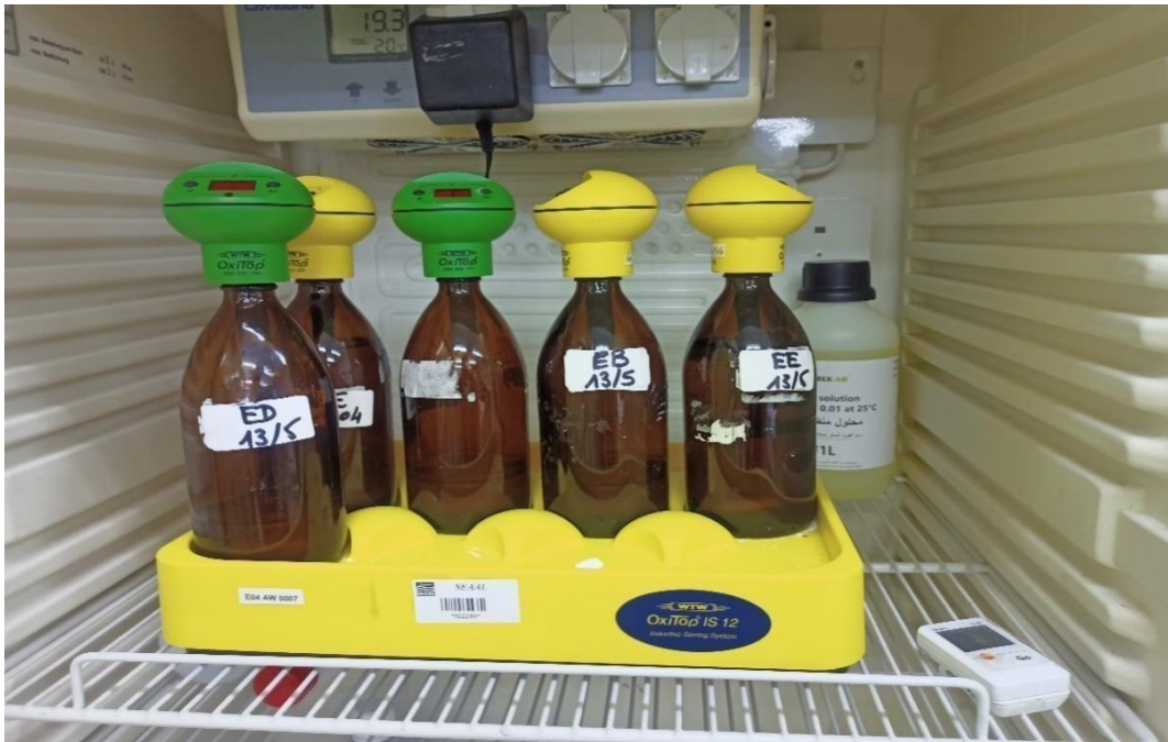
Figure III.11: Dispositif de mesure de la DBO 5 .
