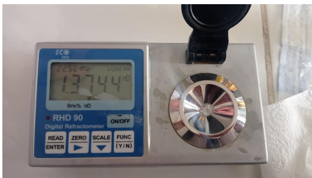
FIGURE 41: IMAGE REPRESENTE L'INDICE DE REFRACTION MESURE PAR LE REFRACTOMETRE
