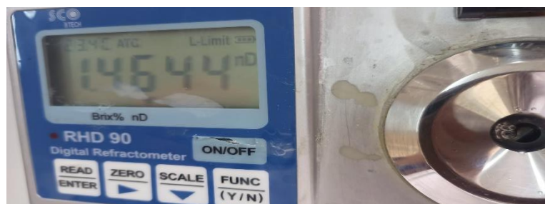
FIGURE 18: IMAGE REPRESENTE L'INDICE DE REFRACTION MESURE PAR LE REFRACTOMETRE
