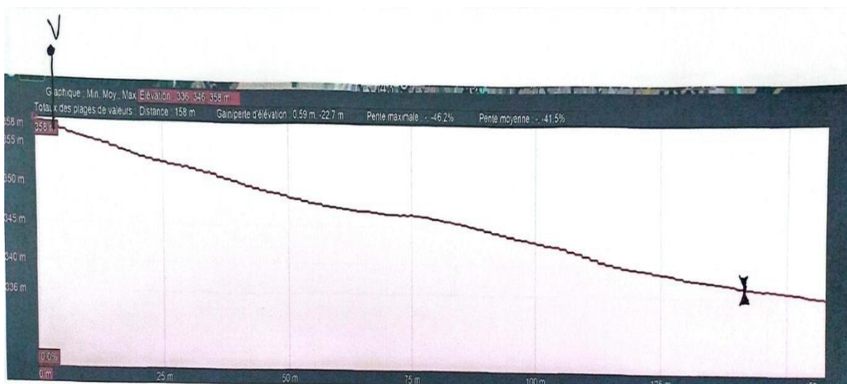
Figure VI.14 : l'emplacement de vanne de vidange et ventouse sur le profil en long
