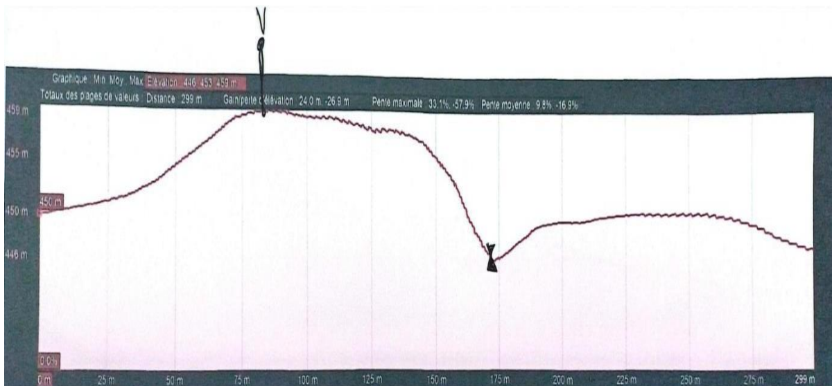
Figure VI.13 : l'emplacement de vanne de vidange et ventouse sur le profil en long
