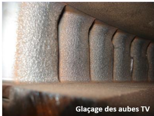
Figure I-20 : Glaçage des aubes TV
