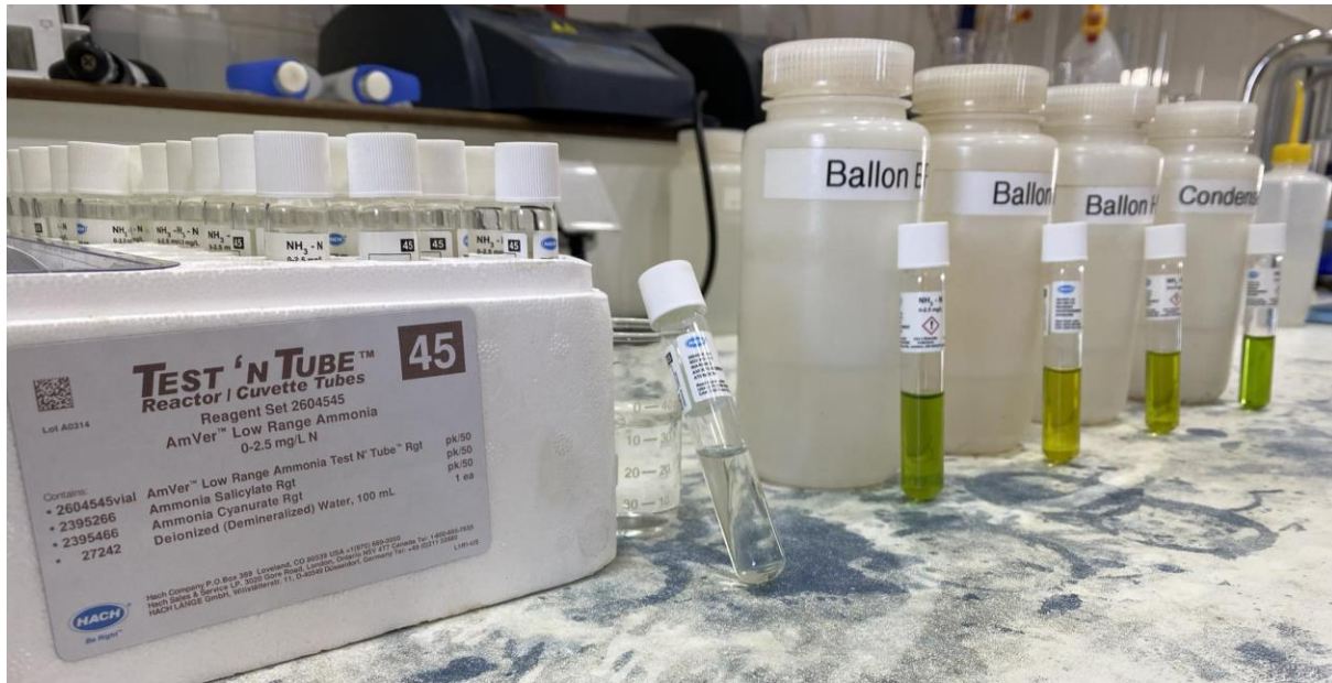
Figure II-8: analyse physico-chimique de l'ammoniac
