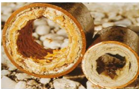
Figure I-17 : dépôts des particules solides sur les tuyaux
