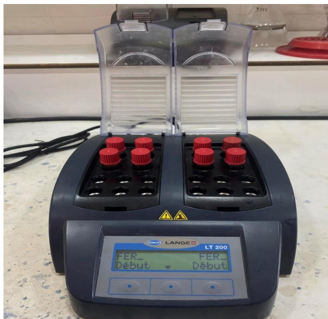
Figure II -3: Réacteur thermique LT200
