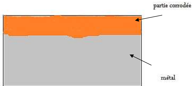
Figure I.2 Schéma de corrosion uniforme.
