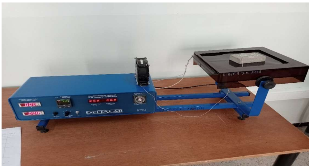
Figure VI. 13 : Conductivitémètre au laboratoire avec le mortier
