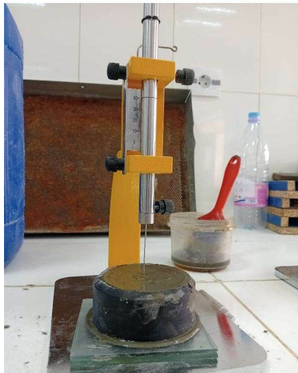
Figure VI . 4 : Essai de prise.
