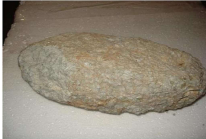
Figure I. 4 : Scories de perlite provenant de Hammam BOGHRARA avant le processus de broyage. [HAMDACHE, 2017]
