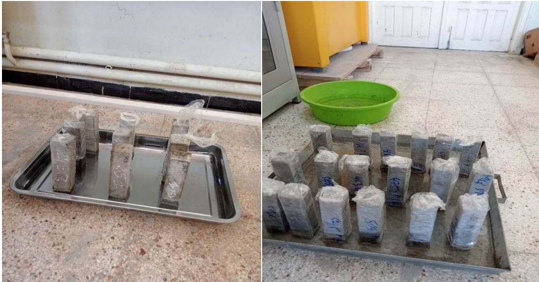
Figure VI. 9 : Eprouvettes dans le récipient en position verticale avec un niveau d'eau constant 3 mm.
