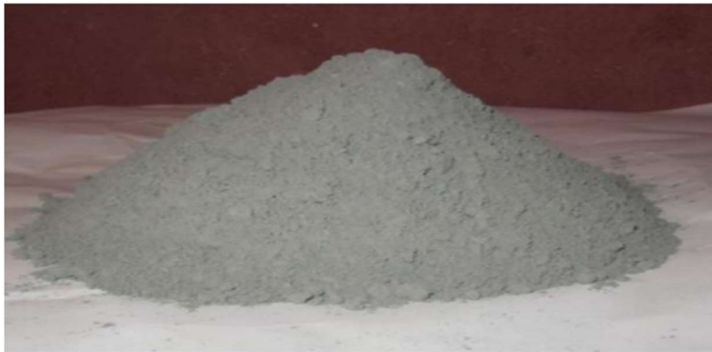
Figure I. 9 : La poudre de perlite après le broyage et tamisage
