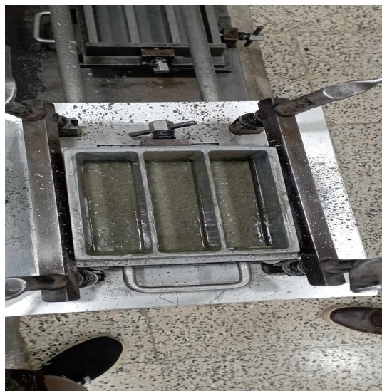
Figure VI. 8 : Moule d'éprouvettes prismatiques (40x40x160) mm
