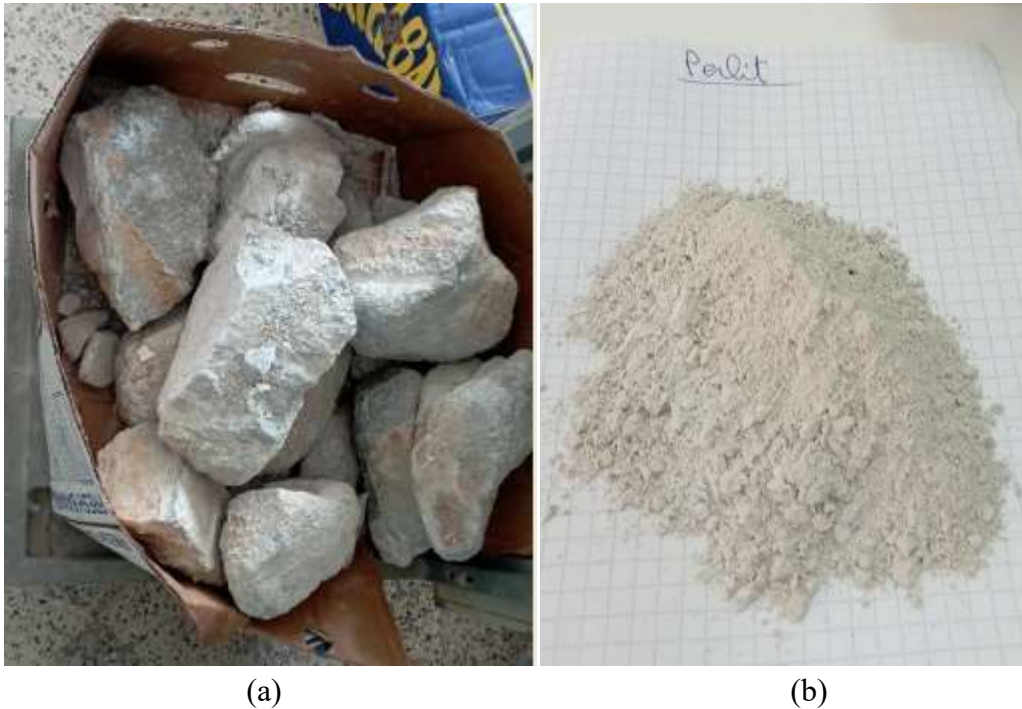
Figure III. 3 : (a) La perlite naturelle sous forme de roche avant le processus de broyage, (b) La perlite naturelle réduite en poudre après broyage
