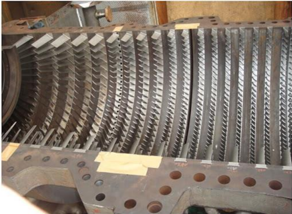
Figure I. 9: Stator du compresseur d'une turbine à gaz [7]
