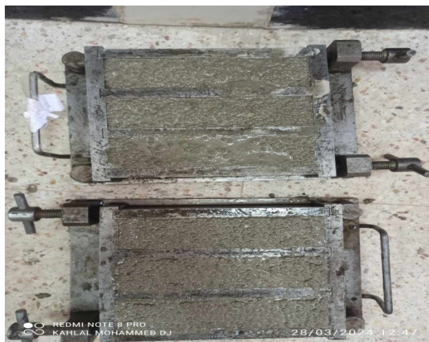
Figure III.57. Eprouvette prismatique (4x4x16) du mortier de polystyrène
