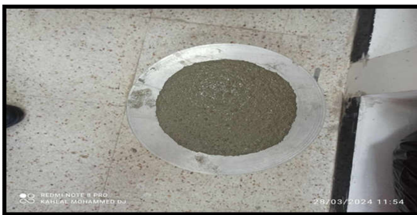
Figure III.60. L'essai de l'étalement de mortier
