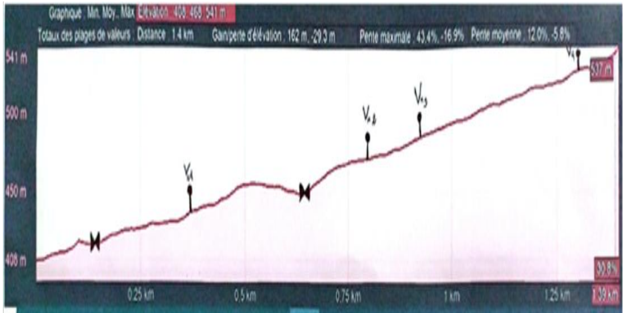
Figures VI. 15 : L'emplacement des ventouses et vidanges sur le profil en long.
