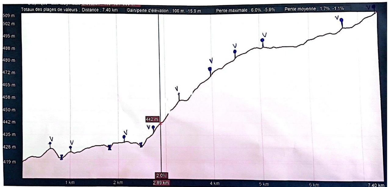
Figure (VI.7) : Emplacement des ventouses et vidange pour tronçon sp2 vers sp3
