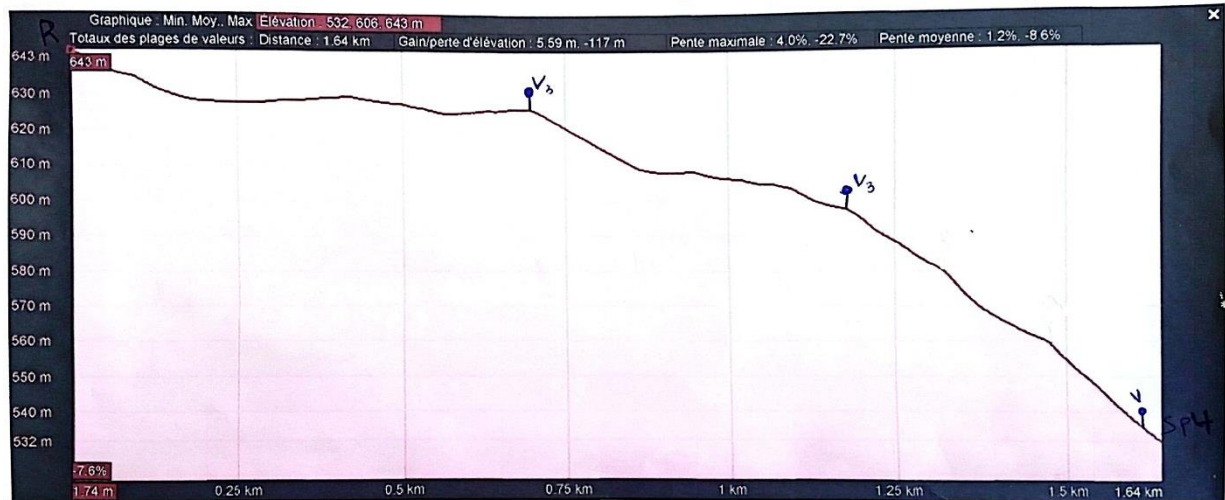
Figure (VI.9) : Emplacement des ventouses et vidange pour tronçon sp4 vers R1000
