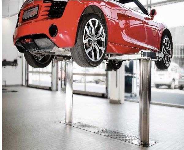
Figure II.12. Pont à deux vérins
