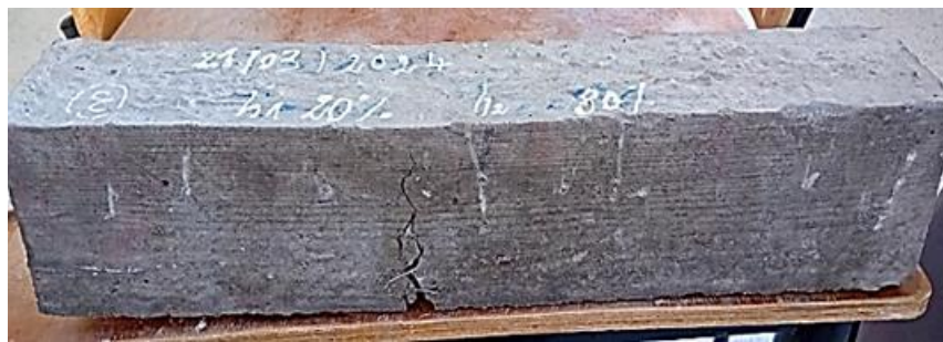
Figure IV.10. Mode de rupture de la Poutre multi couche (p- 80% 20%).
