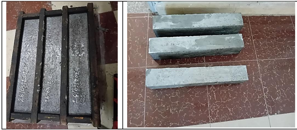
Figure III.25. Démoulage des éprouvettes
