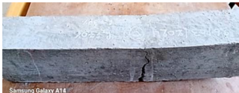
Figure IV.8. Mode de rupture de la Poutre multi couche (p- 70% 30%).
