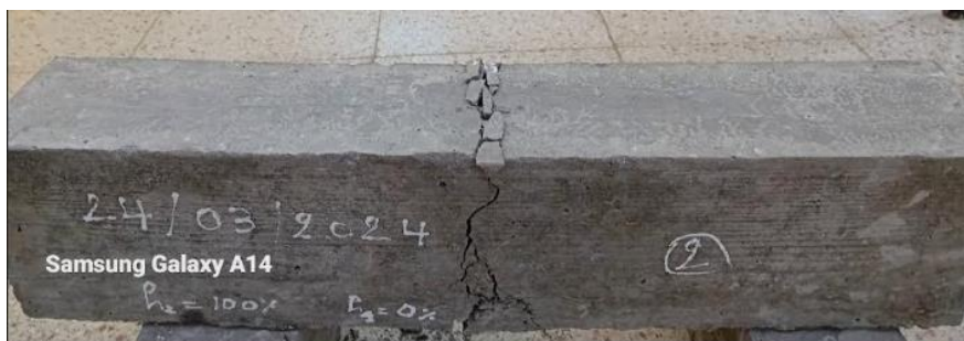
Figure IV.12. Mode de rupture de la Poutre multi couche (p- a100%b 0%).
