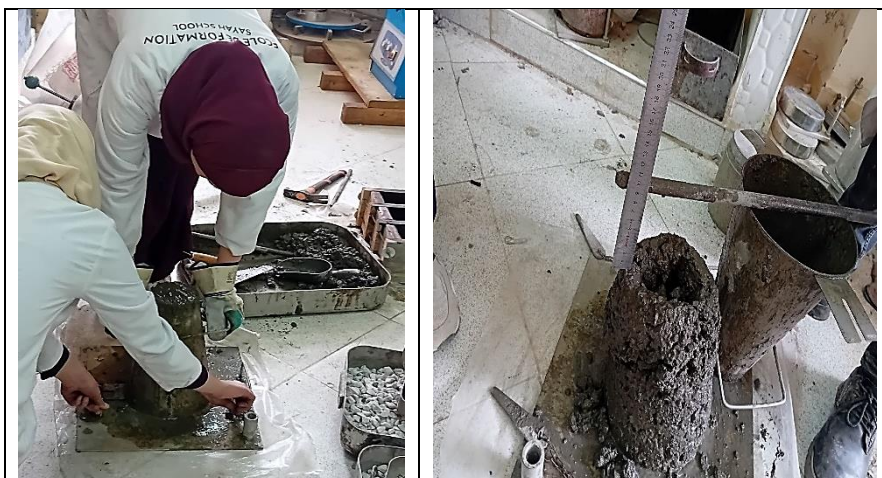
Figure III.22. Mesure d'affaissement.
