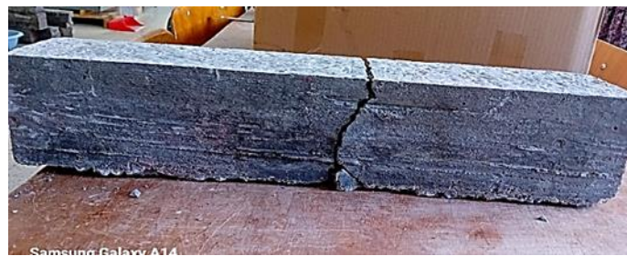
Figure IV.2. Mode de rupture de la poutre témoin (P-Réf)
