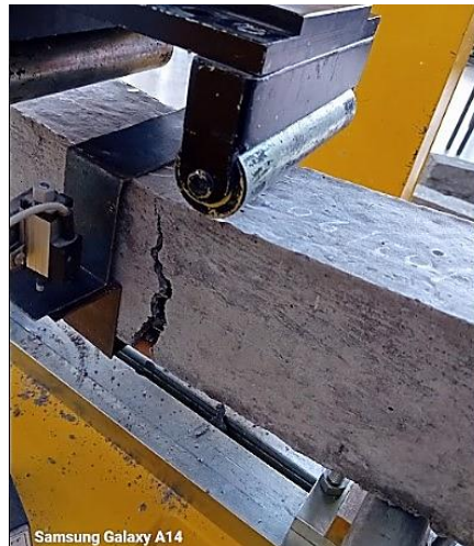
Figure IV.4. Mode de rupture de la poutre en BAF (P-ST).
