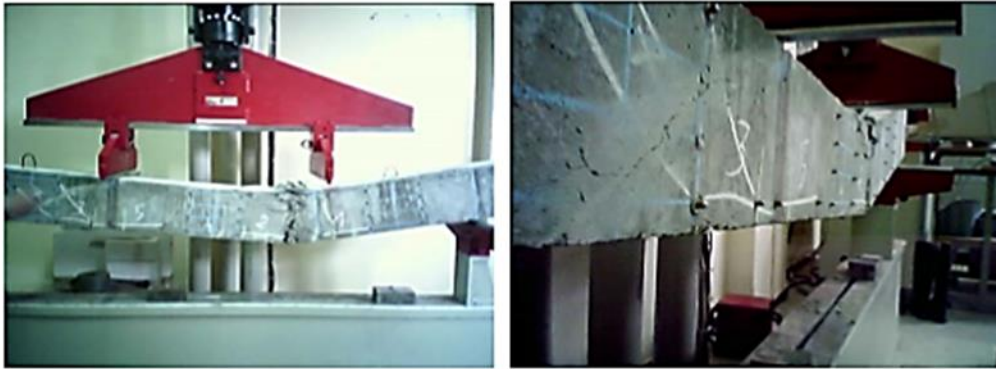
Figure II.34. Rupture des poutres en béton de fibres métalliques courtes et longues.
