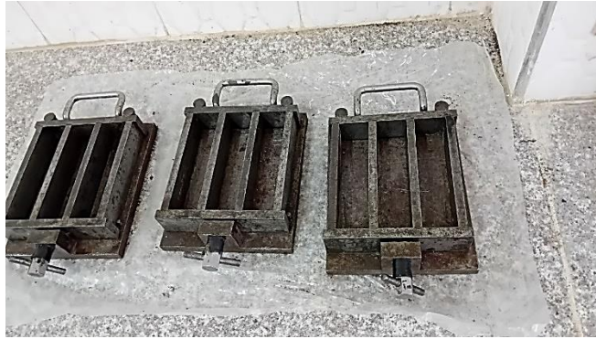
Figure III.11. Moules prismatiques (4 x 4 x 16 cm 3 )
