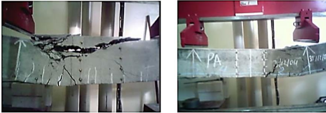
Figure II.31. Rupture des poutres en béton et en béton de fibres.
