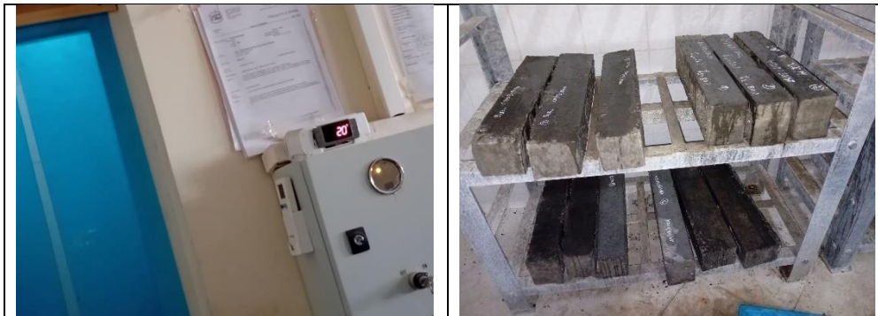
Figure III.26. Préservation des éprouvettes dans chambre humide pendant 28 jours
