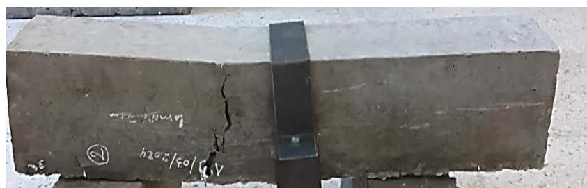
Figure IV.6. Mode de rupture mi-hauteur (P-MH)
