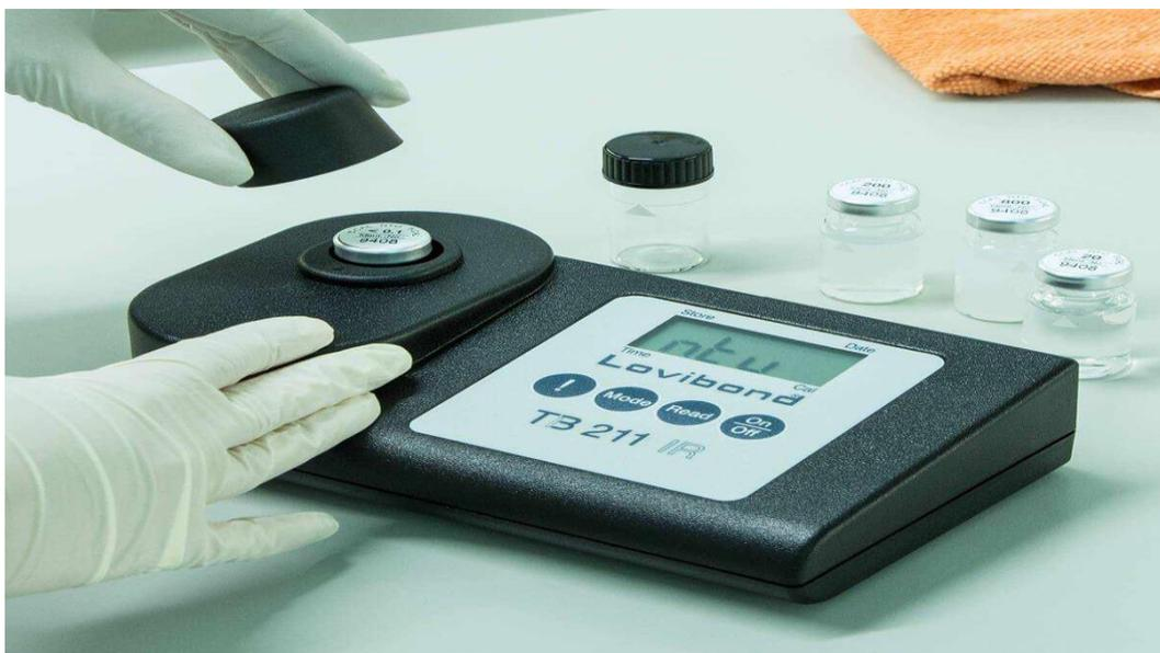
Figure III.2 : turbidimètre
