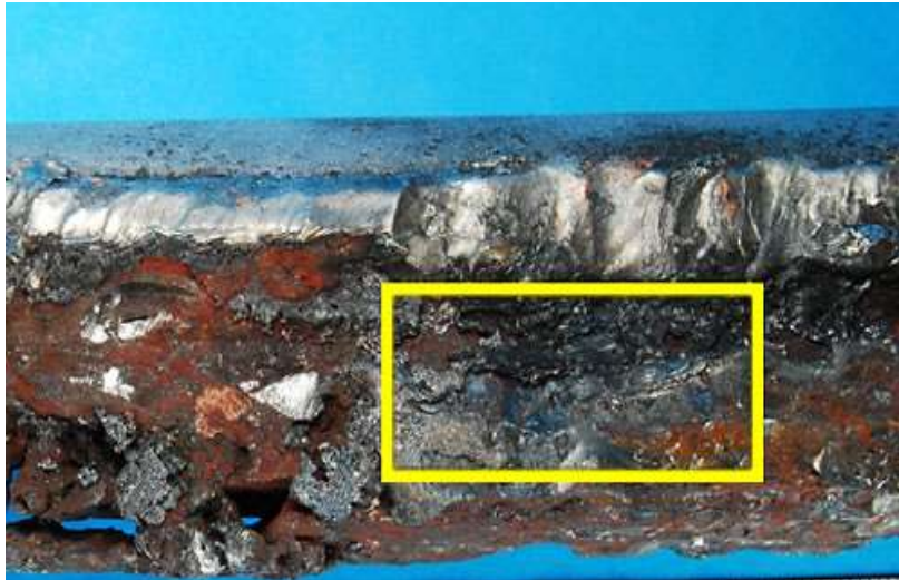
Figure II.12 – Fissure résultant de la fatigue-corrosion.
