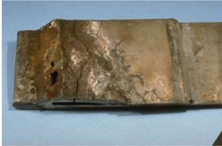
Figure II.5 – Corrosion sous contrainte ( Fissuration sous contrainte due à la corrosion dans une structure en acier allié soudée (contraintes induites par le soudage). )
