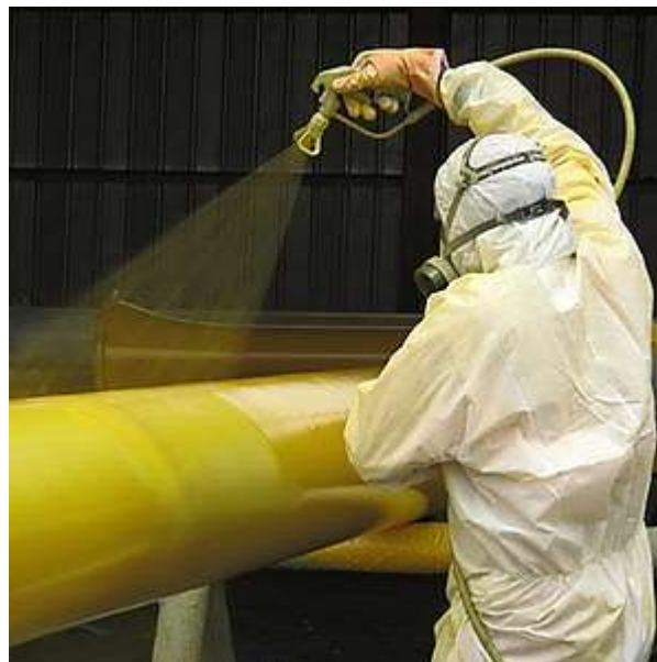
Figure III.4 - Protection par revêtements.
