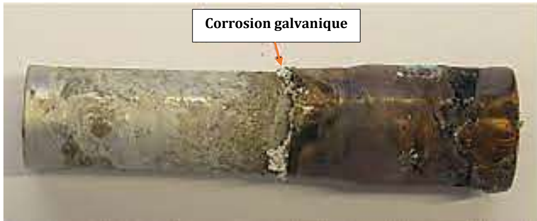
Figure II.2 – Corrosion galvanique de l'aluminium assemblé au cuivre.
