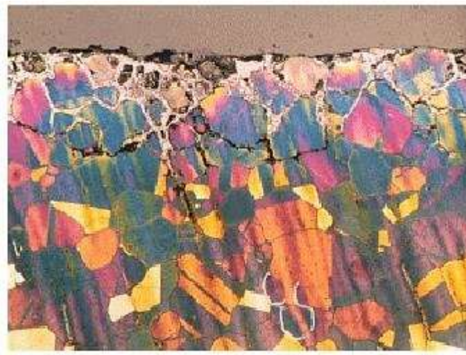
Figure II.8 – Corrosion intergranulaire d'un acier inoxydable dans l'acide chlorhydrique.
