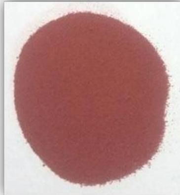
Figure II. 30 : Echantillon d'époxy poudre riche de zinc
