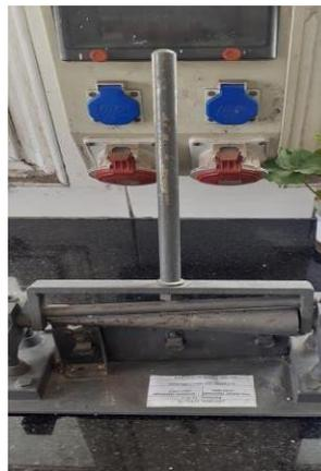
Figure II. 18 : Appareil de pliage muni d'un mandrin conique
