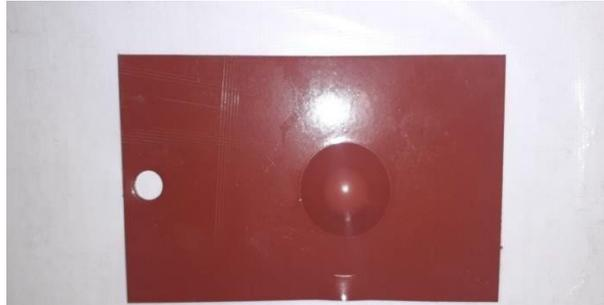
Figure III. 3 : Le Teste de l'emboutissage
