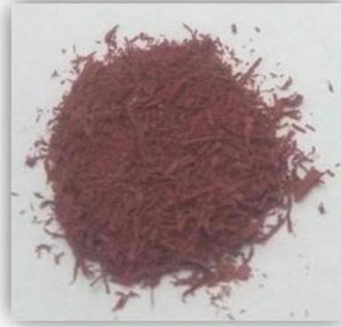
Figure II. 31 : Echantillon de filme polymérisé après broyage
