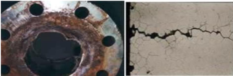
Figure I. 6 : Corrosion sous-contrainte
