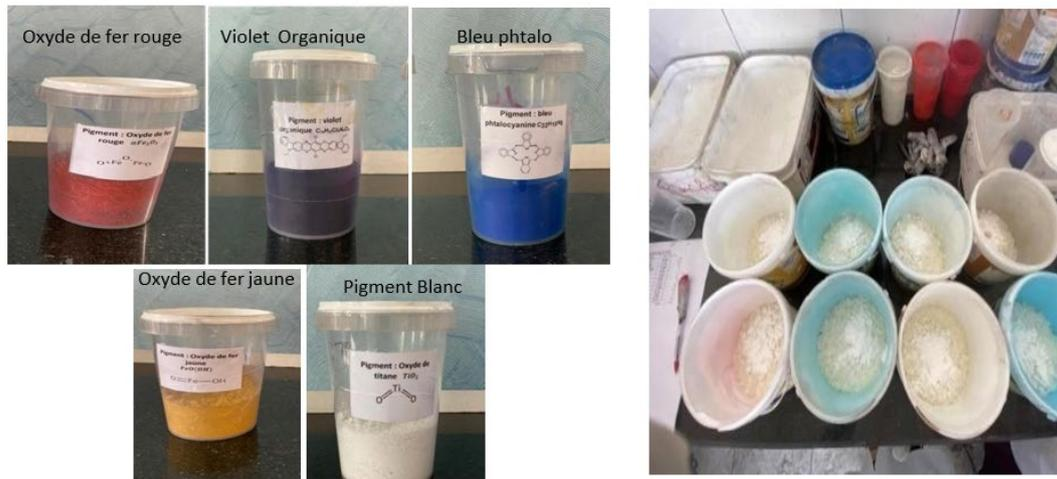
Figure II. 6 : Les pigments Utilisées. Et PHOSFATE DE ZINC Charges (sulfate de baryum) +Résine Epoxy
