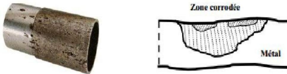
Figure I. 8 : Corrosion par piqûres
