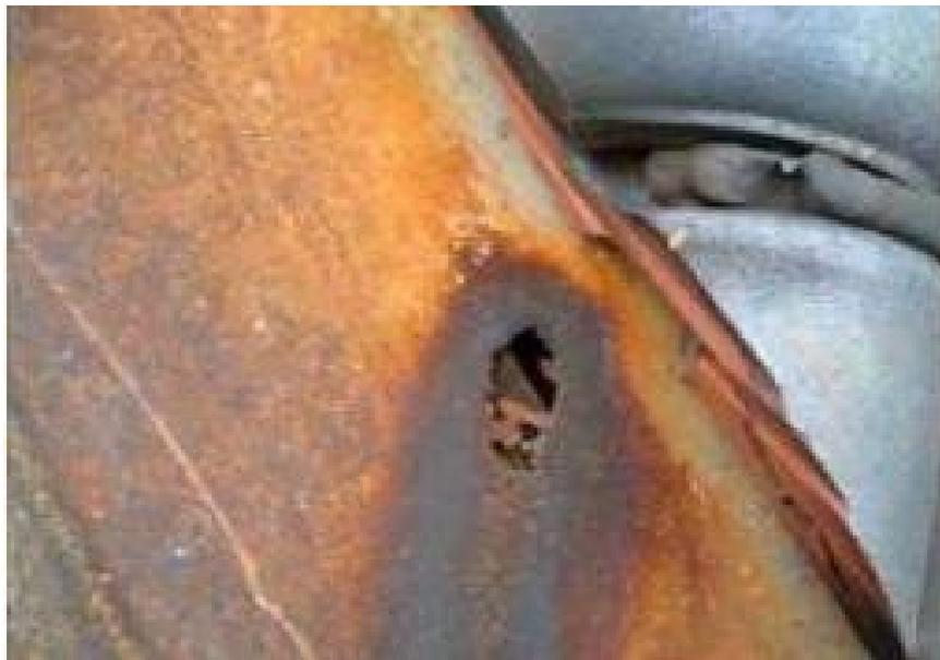
Figure I. 4 : Corrosion localisée
