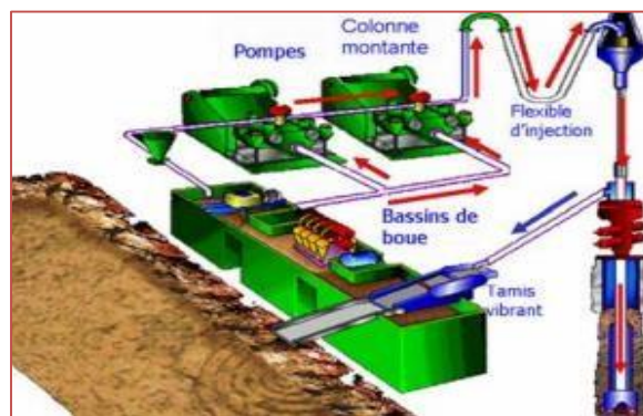
Figure 11: Cycle du fluide sur le site de forage. (Schlumberger, 1997)
