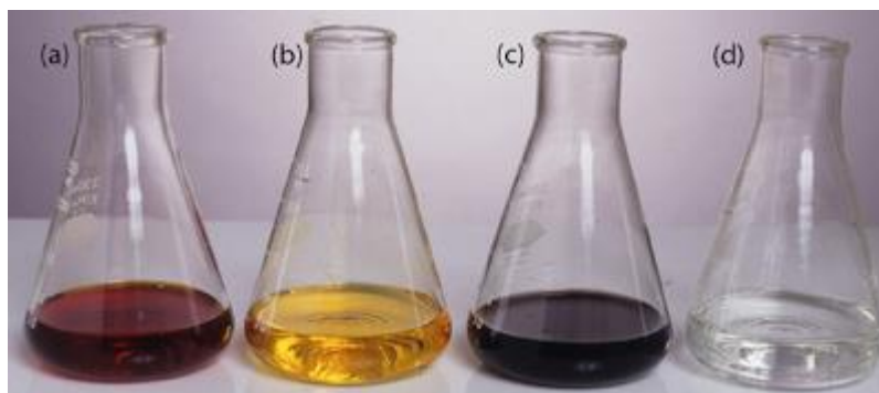
Figure .III. 1: Test titrimétrique du chlore active dans l'hypochlorite
