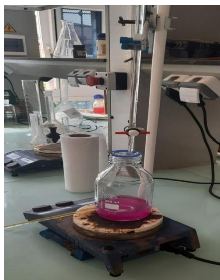
Figure .III. 8: Neutralisation de silicate sodium par HCl
