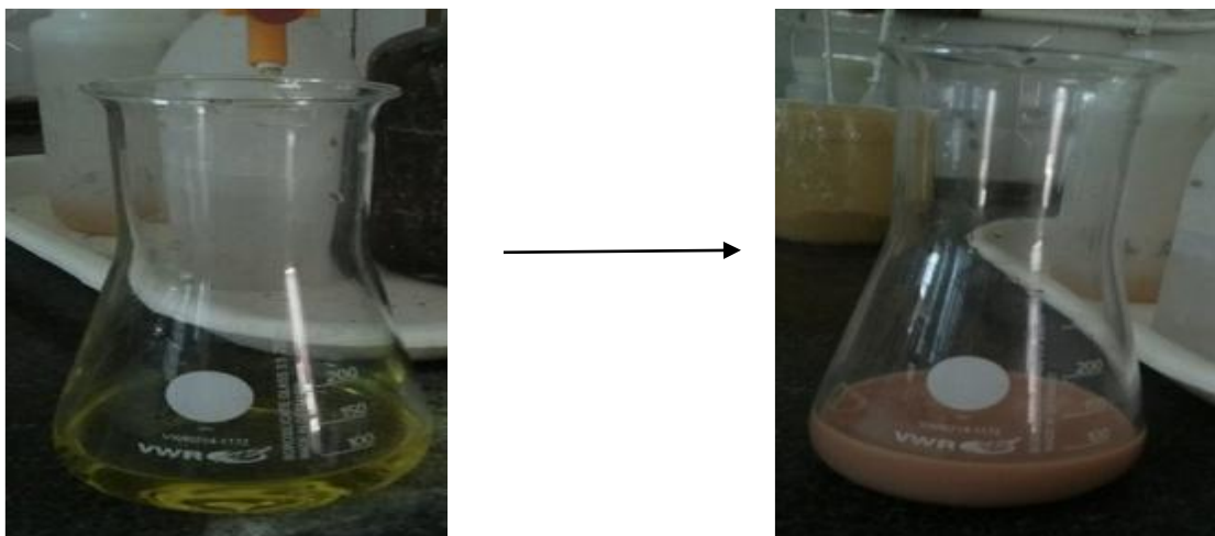
Figure .III. 2: Test de concentration de chlorure totale
