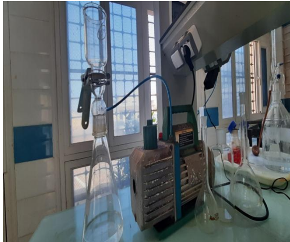
Figure. III.10: Filtration sous vide
