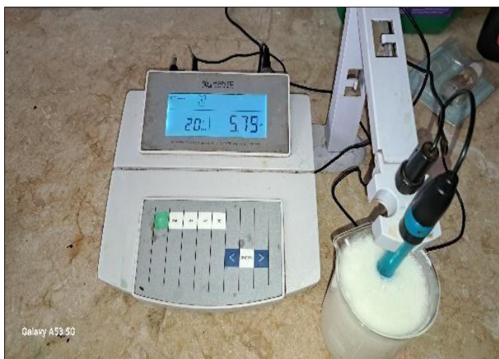
Figure III.13. Mesure de pH de shampoing à l'aide d'un pH-mètre.
