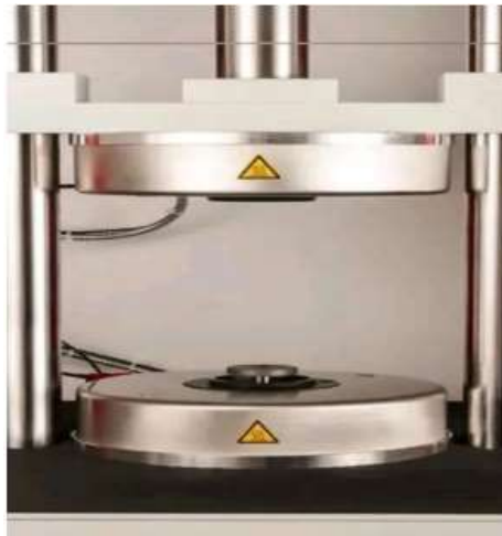
Figure III.15: Chambre du Mooney viscosité
