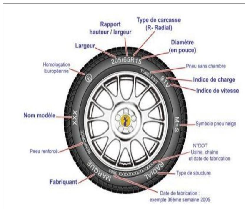
Figure I.4. Marquage d'un pneu.
