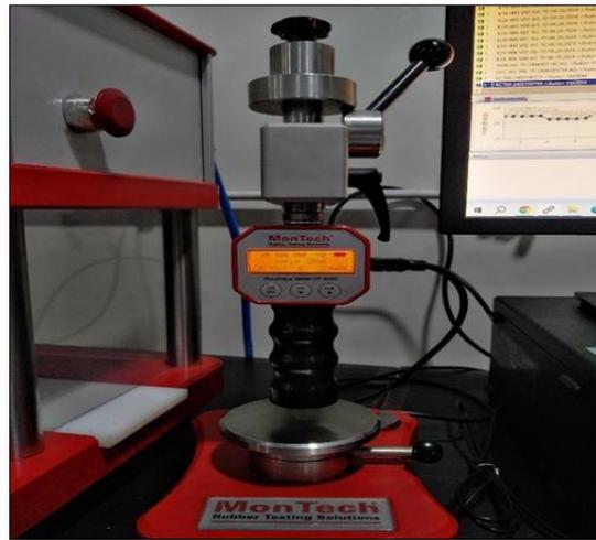
Figure III.15. Duromètre.
