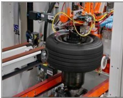
Figure I.9. Contrôle de qualité par la machine ZF.
