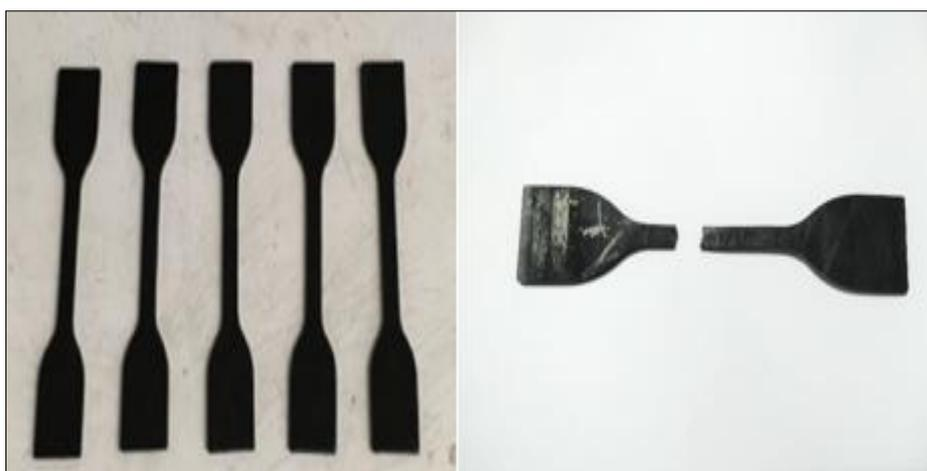
**Figure III.14.** Allure de l'évolution de la déformation d'une éprouvette états initial et rupture.
