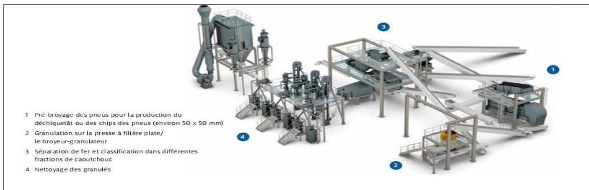
Figure I.10. Procédé de recyclage des pneus.
