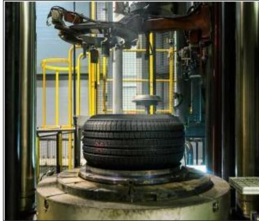
Figure I.8. Pneu sortie du moule.
