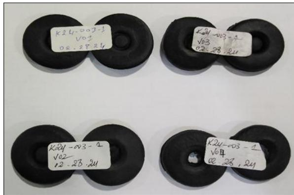
**Figure III.9.** Echantillons de Mooney test.
