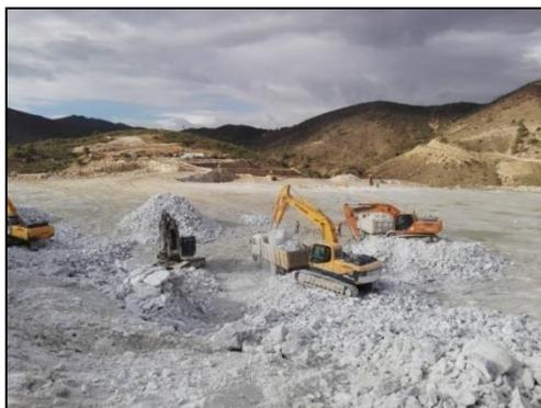
*Figure I.4 : Transport de gypse concassé avec des camions vers l'usine*
