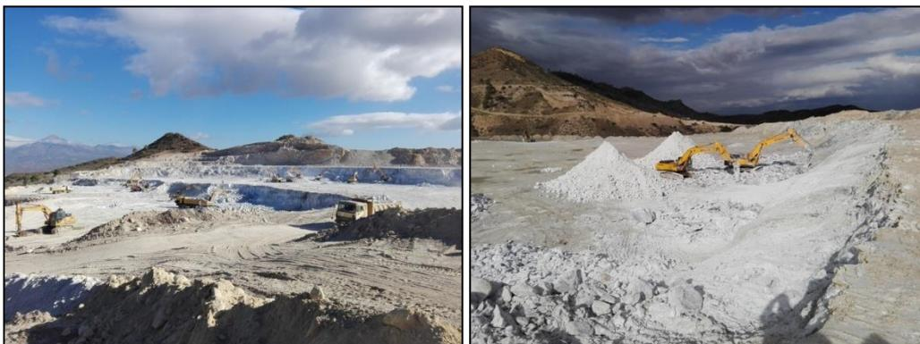
*Figure I.3 : Extraction du gypse avec des camions brise roche à ciel ouvert*
