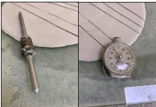
*Figure II.1 : Les contrôleurs de fin de prise de plâtre (pénétrromètre)*
