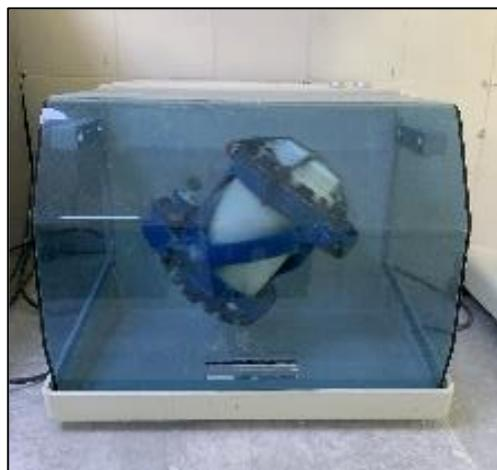
*Figure II.3 : Plâtre et l'accélérateur dans le Mélangeur électrique*
