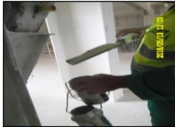
*Figure I.6 : Prélèvement d'échantillon pour un contrôle de qualité*
