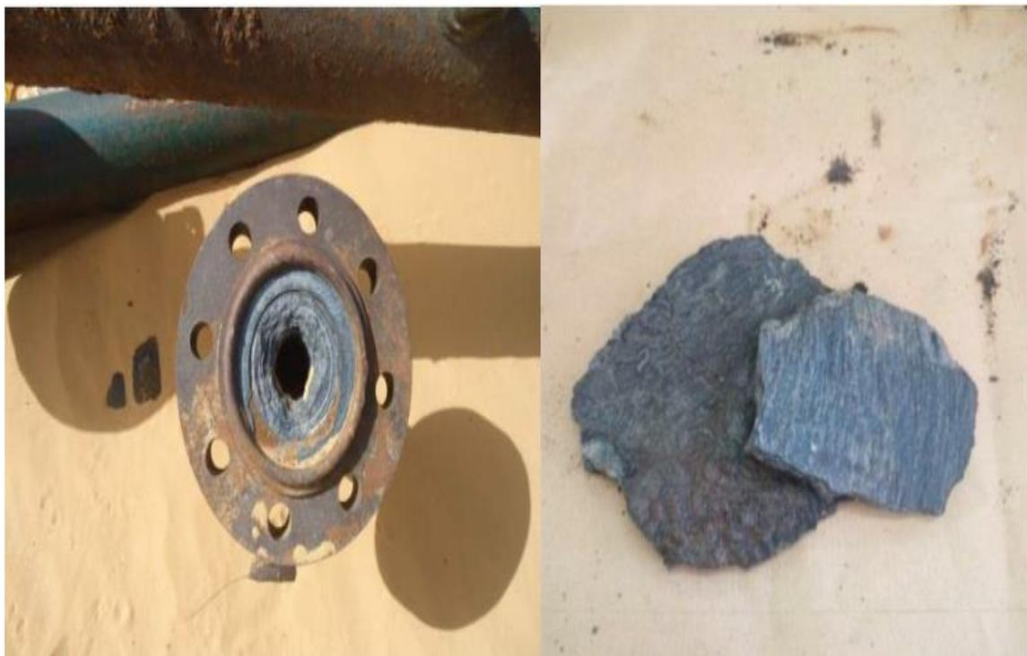
**Figure III.1:** Les dépôts de Sulfate de Baryum  $\text{BaSO}_4$  (DJAOUT, 2021)
