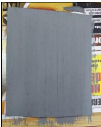
Figure II.11. Application de Galzinepox Gris EA+EB sur une face de la plaque métallique.
