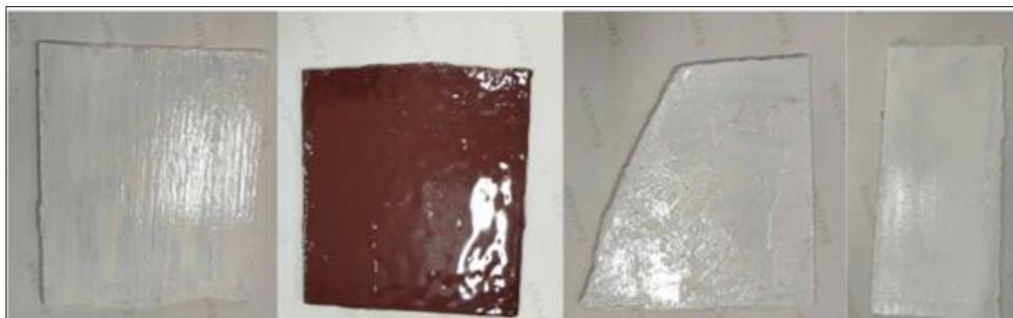
Figure II.13. Application de la troisième couche pour les quatre systèmes (1 à 4 de gauche vers droite).
