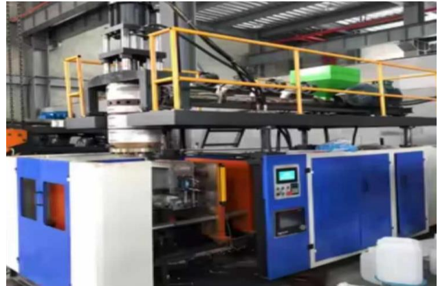
Figure II-11 : Presse de soufflage.
